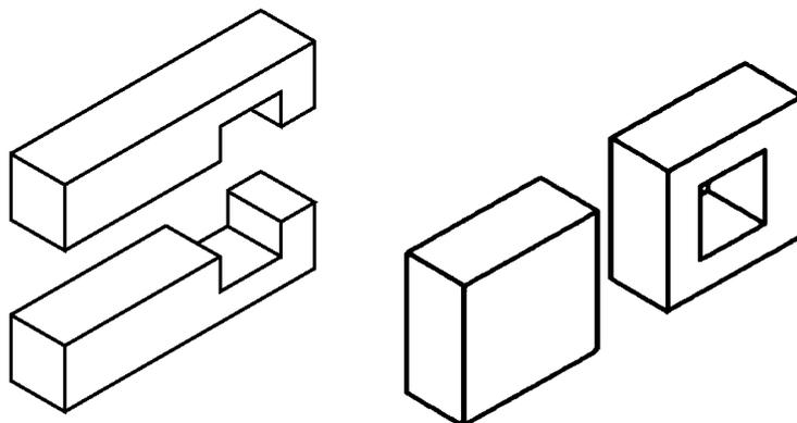
Na figura da esquerda, o modelo ficou dividido em duas partes iguais. Isso quer dizer que o modelo é simétrico em relação ao eixo horizontal. Na figura da direita, o mesmo modelo foi dividido ao meio verticalmente. Você reparou que as duas partes não são iguais? Esse modelo **não é simétrico**, portanto, em relação ao eixo vertical.
