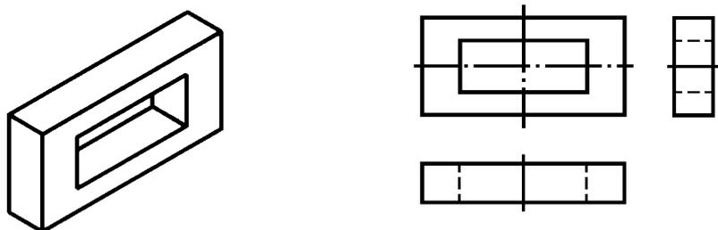
O prisma com furo passante retangular é simétrico em relação aos dois eixos horizontal e vertical. Na vista frontal, as duas linhas de simetria estão indicadas. Na vista superior, está representada a linha de simetria vertical. Na vista lateral esquerda, está representada a linha de simetria horizontal.
