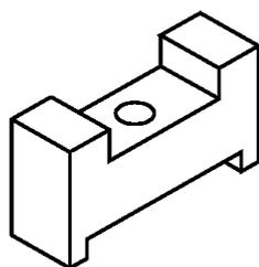
Este modelo prismático tem dois rasgos paralelos, atravessados por um furo passante. No desenho técnico deste modelo, é necessário determinar o centro do furo.
