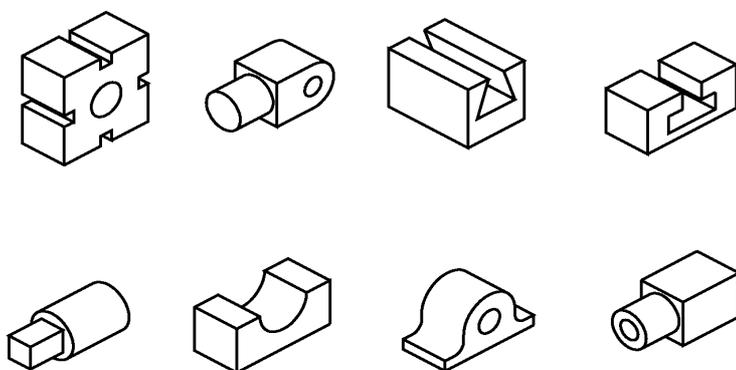
Assim, a linha utilizada em desenho técnico para indicar o centro desses elementos é chamada de **linha de centro**, representada por uma **linha estreita de traço e ponto**.
