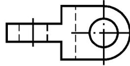
As projeções dos dois furos horizontais coincidem na vista frontal. Esses furos têm a forma de círculos. Para determinar seu centro, usamos duas linhas de centro que se cruzam.
