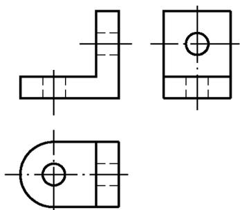
Os centros de elementos **paralelos** e **oblíquos** também devem ser indicados pela linha de centro, para possibilitar a correta execução do modelo. Observe, nas ilustrações a seguir, a aplicação da linha de centro em modelos com elementos paralelos e oblíquos.
