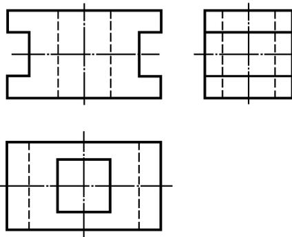
Os modelos também podem ser simétricos apenas em relação a um eixo, como vemos na figura ao lado, que tem um **furo não centralizado**.
